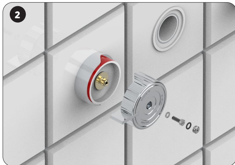
Positionnement de la bague pour les croisillons Zoom / Positioning the ring for the Zoom braces
